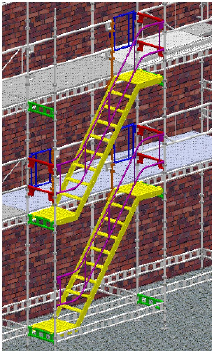
Fortsett med å montere UTV trapper med UTV Rekkverk og Enrørsbjelker eller Dobbelt rek-kverk.
